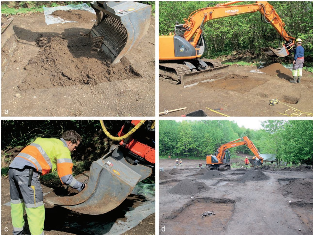
Figur 2.6.5. Maskinell gravning av 2 \times 2 m store ruter erstattet den manuelle gravningen av 0,5 \times 0,5 m store prøvekvadranter på lokaliteter i åkermark. Jordmassene fra disse rutene i pløyselaget ble såldet i en spesiell såldeskuffe på gravemaskinen. (a) Såldeskuffen besto av en åpen skufferamme hvor bunnen var dekket med netting med maskevidde på 2 \times 2 cm. Den maskinelt såldede jorden fra utvalgte ruter ble deretter også såldet manuelt med tradisjonell 4 \times 4 mm maskevidde. (b) Feltdleder Lotte Carrasco overvåker den maskinelle såldingen på Gunnarsrød 6. (c) Utgravningsleder Gaute Reitan går igjennom det som ligger igjen i såldeskuffen etter at jorden er siktet gjennom nettingen. (d) Metoden ble anvendt på åkermarkslokalitetene Gunnarsrød 5 og 6 og Vallermyrene 2 og 3. På Gunnarsrød 5 (bildet) ble 38 slike ruter gravd, noe som ga nær 800 littiske funn. Bilde tatt mot vest.
