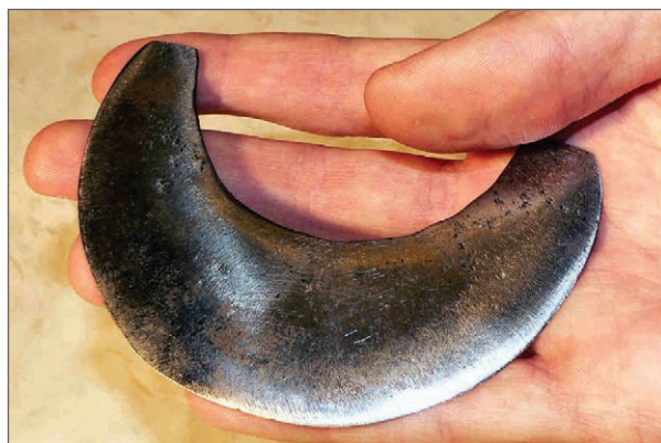
Figur 2: Rekonstruktion af halvrund kniv af fosforjern. Foto: M. Nielsen.
