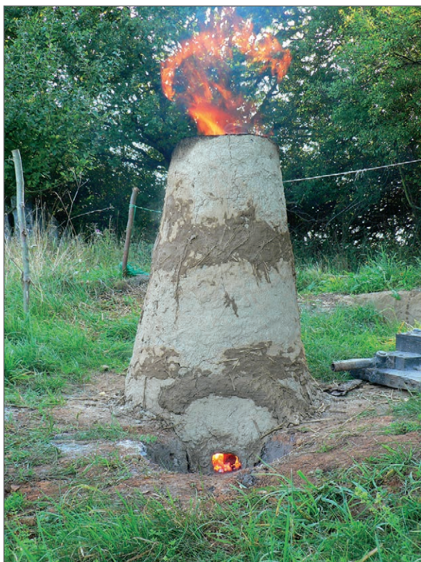
Figur 7: Slaggeaftapningsovn i anvendelse, Lejre 2009. Foto: H. Lyngstrøm.
