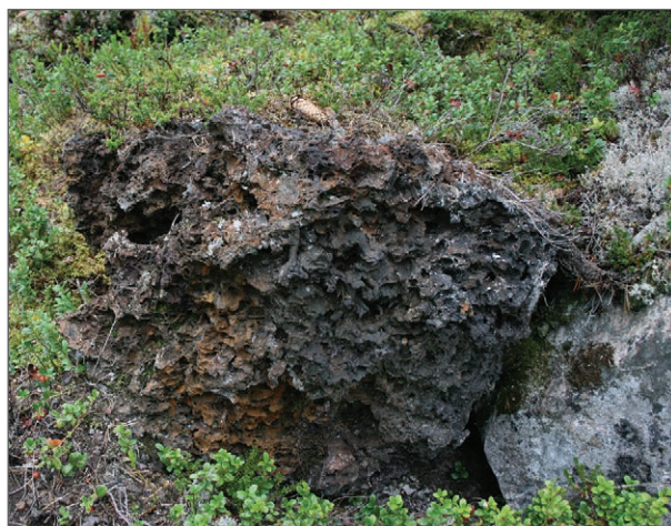
Figur 6: Slaggblokk fra Smådøla, Nore og Uvdal kommune, Buskerud. Slike blokker finnes på anlegg med ovner av østlandstypen og kan være opptil 1 m i tverrmål. Slagget har tydelige vedavtrykk. Foto: B. Rundberget, Kulturhistorisk museum.
