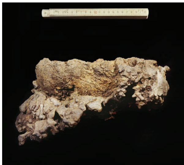
Figur 4: Slagge fra Espevej. Slaggen har hængt i overgangen mellem ovnskakten og slaggedrænet.
